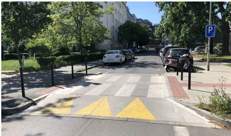
13 Priechody pre chodcov v upokojených a obytných uliciach je nevyhnutné umiestňovať na úrovni chodníka. Takéto riešenie zvyšuje bezpečnosť a zároveň podporuje bezbariérový pohyb. Bratislava, Bernolákova ulica
